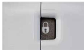
Шаг 18: положение «замок» – активирована защитная блокировка. Аппарат не заряжен кассетой, кассета вставлена неправильно или уже прошита.
