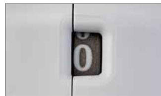
Шаг 14: все шаги прошивания отображаются на мониторе-индикаторе ходов ножа. При значении «0» – процесс прошивания еще не начат или уже полностью завершен и нож вернулся в исходное положение.
